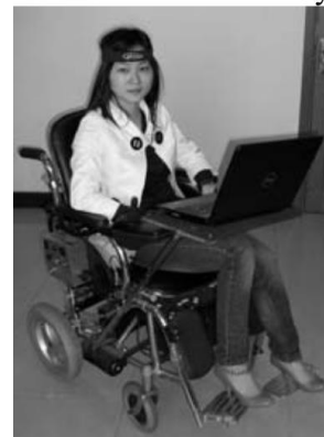
Figura 5.- Silla de ruedas controlada por medio de una interfaz que captura las señales sEMG, imagen obtenida de (Yi et al., 2011).
