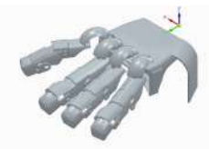
Figura 1. Diseño de la órtesis realizado en Solid Edge 2023
