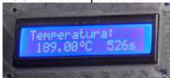
Fig. 9. Pantalla LCD con información de temperatura y tiempo obtenida del sistema DAQ. Fuente: Elaboración propia.
