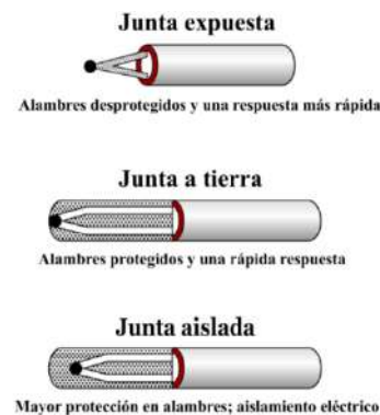
Fig. 1. Estilos de junta caliente para termopares. Fuente: [6].
