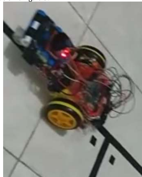
Fig. 8. Señales de bifurcación que el vehículo puede detectar por medio de los sensores reflectivos externos.
