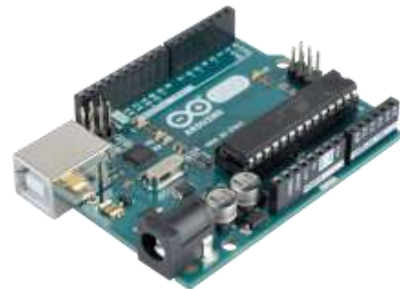
Fig. 3. Placa de desarrollo Arduino UNO.
