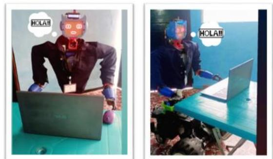
Fig. 13: robot en pruebas de detección de rostro.
