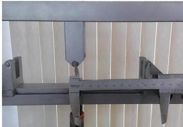
Figura 6. Ajuste de la distancia entre pernos.
