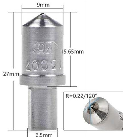
Figura 1. Penetrador cónico de diamante (Brale). Adaptado de: Diamond Indenter HRC-3 Para Probador de Dureza Diamond Indenter 120 Grados Para Rockwell: Amazon.com.mx: Industria, Empresas Y Ciencia, 2024.
