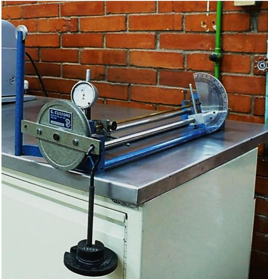
Figura 4. *Dispositivo de torsión.*
