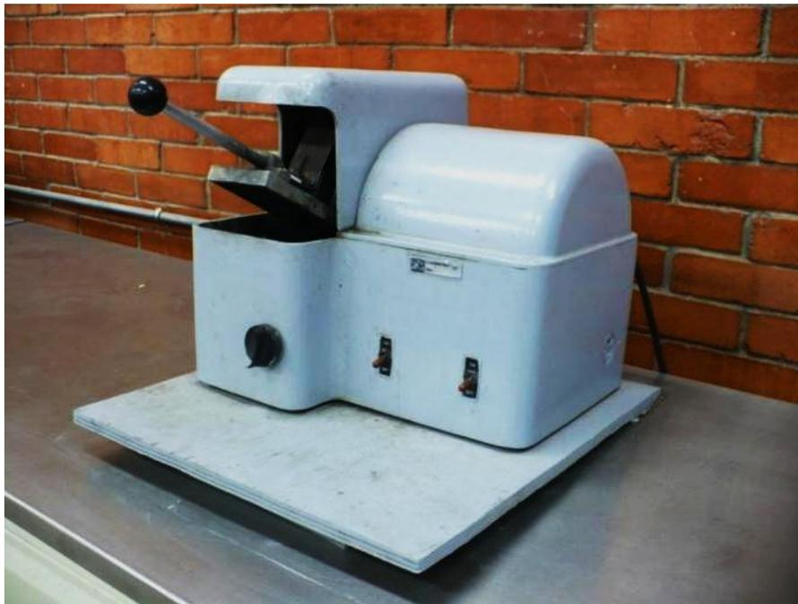
Figura 1. Cortadora de disco abrasivo.
