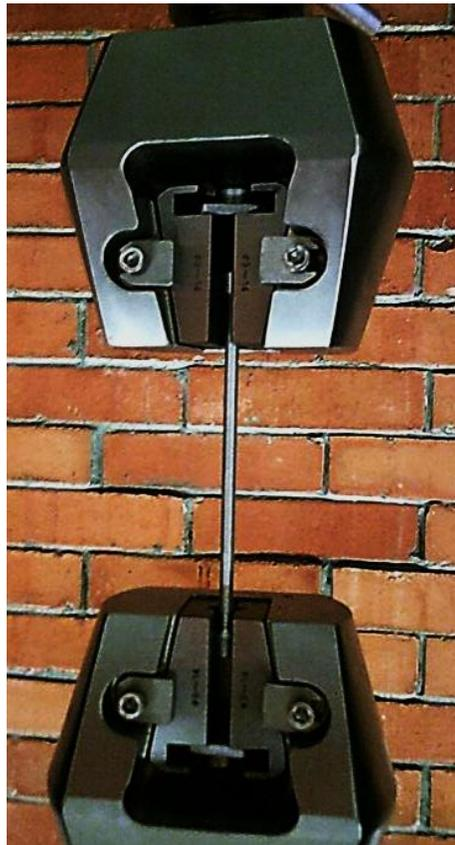
Figura 4. *Probeta colocada en las mordazas.*
