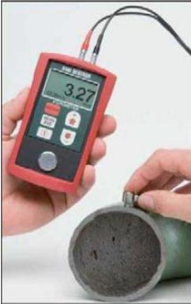
*Figura 2.5 Medición de espesores*
