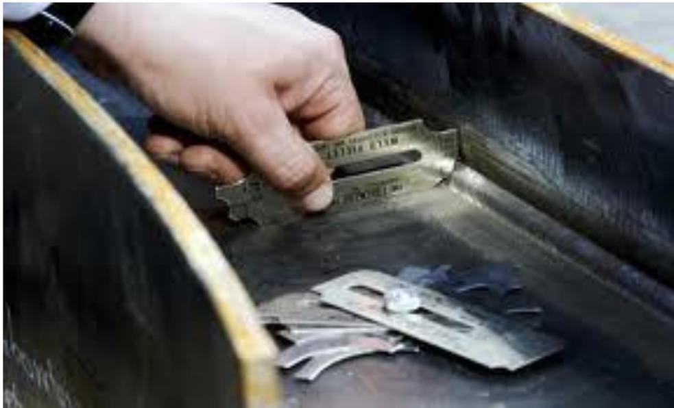
*Figura 2.1 Verificación dimensional de una soldadura*
