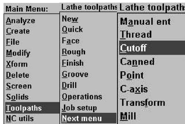
Figura 3.74.- Secuencia de operaciones para el Tronzado de la pieza.
