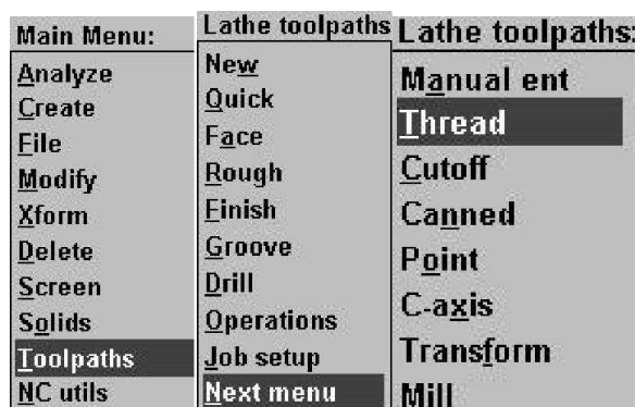
Figura 3.71.- Secuencia a seguir para la operación de roscado.
