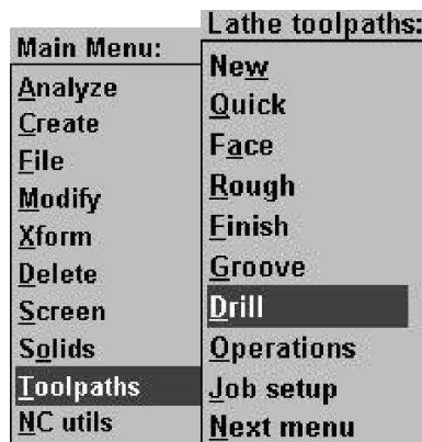
Figura 3.68.- Secuencia para barrenado.
