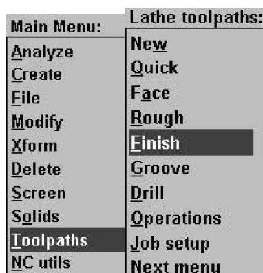
Figura 3.57.- Secuencia de operaciones para realizar el afine.
