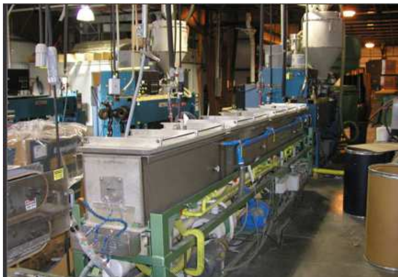
Figura 5.5. – Fabricación automatizada de azulejos de plástico.
