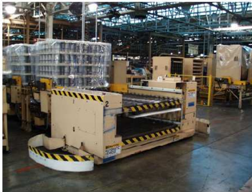
Figura 4.9. Un AGV Auto-Trans con sistema de guiado inercial bidireccional y una cama transportadora de dos niveles se prepara para recoger un lote de piezas para motor.
