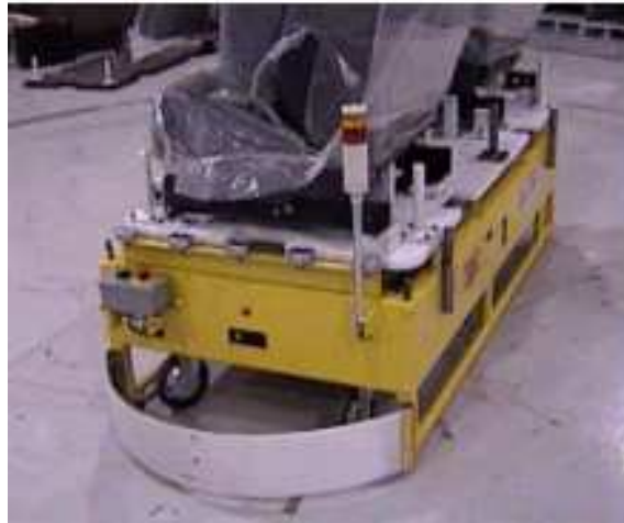
Figura 4.7. AGV siguiendo una trayectoria inductiva o filoguiada.
