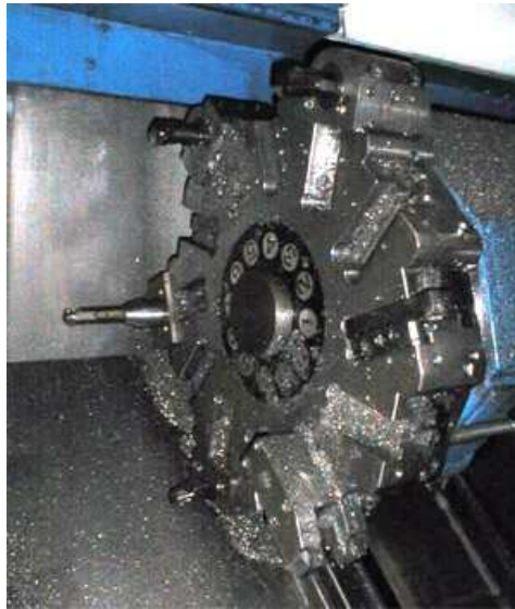
Figura 2.23. Torreta de 12 herramientas diferentes en un torno.
