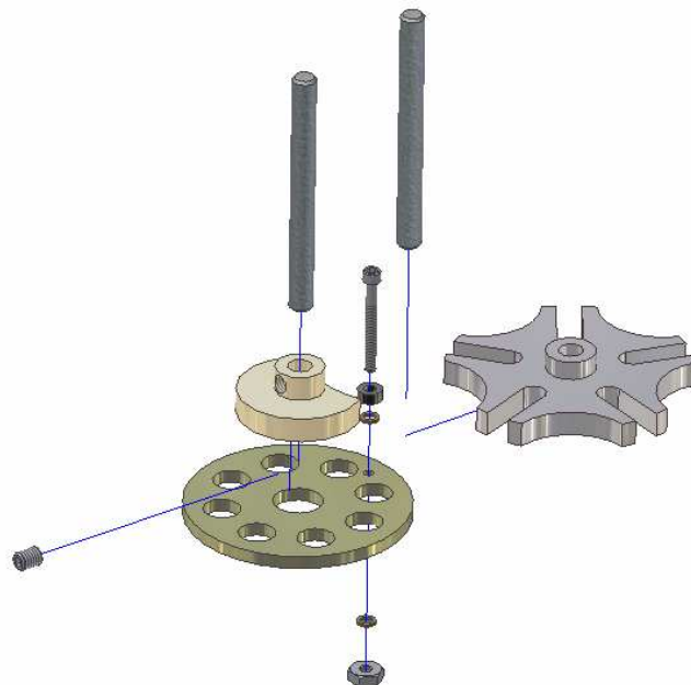
Figura 4.2B Vista de explosión del mecanismo leva cruz de Malta.
