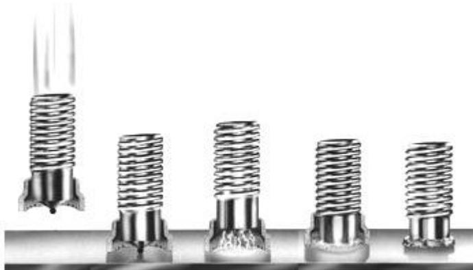
*Figura 10. Soldadura de pernos (Stud weld)*
