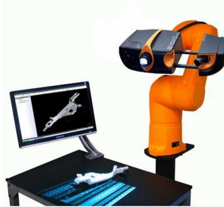
*Figura 8.25. Equipo nub3d trabajando conjuntamente con un robot.*
