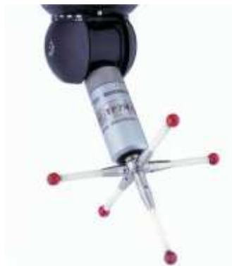
*Figura 8.18. Palpador de una CMM*
