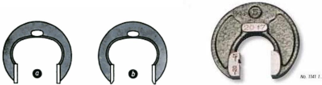
*Figura 8.3. Calibre de una sola herradura para árboles con diámetros entre 100 y 400 mm*
