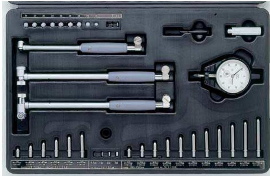
*Figura 8.5. Juego de alesámetros 18-150 mm – apreciación 0,01 mm*
