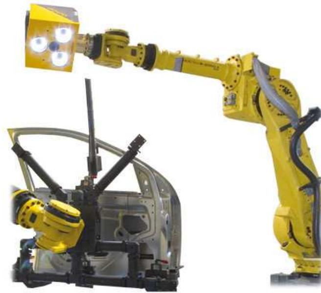
*Figura 8.22. Equipo Cognitens Opticell, medición óptica automatizada en 3D para el taller.*
