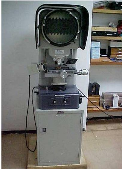
*Figura 8.13. Analizando el perfil de una rosca*
