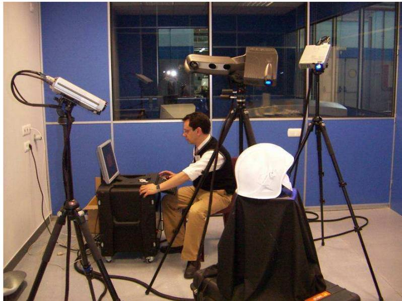
**Figura 8.31. Escaneado tridimensional mediante luz blanca estructurada (Fundación Prodintec, España)**
