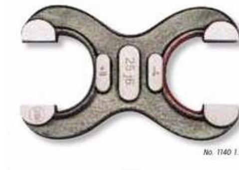
**Figura 8.2. Calibre de doble herradura**
