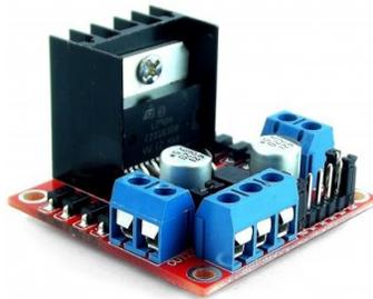
Figura 6.5. Módulo de control de motor a pasos.
