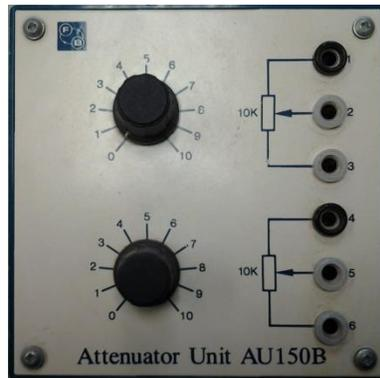
Figura I.4 Unidad Atenuadora AU150B
