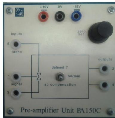
*Figura I.11 Módulo de Pre-amplificador PA150C*
