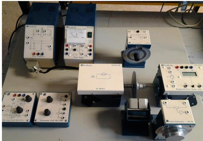
Figura I.1 Servomecanismo modular MS150
