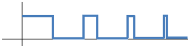
Figura 5.3 Señal de 2 niveles discretos con PWM
