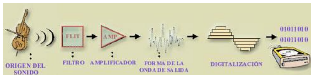
Figura 7.1. Conversión analógica/digital de señales de audio.
