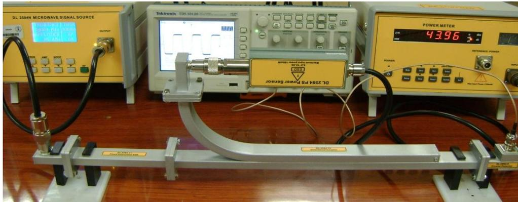
Figura 4.6 Vista del acoplador direccional en arreglo de onda reflejada
