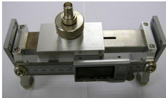
*Selector de Onda Estacionaria SWR*
