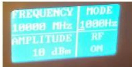
el modo de salida se puede cambiar con la tecla [MODE]. Cuando esté en el modo de salida de modulación por desplazamiento de amplitud, use las teclas [▲ ▼ ◀ ▶] para establecer la frecuencia de portadora requerida.
