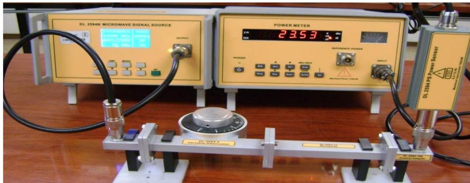
Figura 2.4 Vista de la aplicación del atenuador variable en guías de onda.
