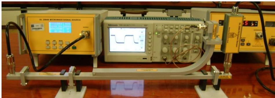
Figura 4.3 Vista de acoplador direccional en onda directa
