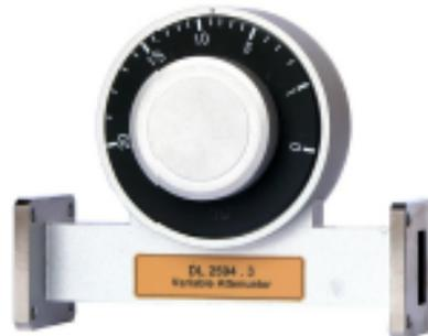
Un atenuador variable proporciona una atenuación variando el grado de inserción de una tira resistiva coincidente en una guía de ondas. El atenuador variable se usa para controlar un nivel de potencia o para aislar una fuente de una carga.
