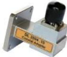
Proporciona una coincidencia entre una guía de onda y una línea coaxial de 50 ohm. El flujo de la potencia puede ser en cualquier dirección. Sin embargo, la SWR en el adaptador debe mantenerse por debajo de 1.2.
