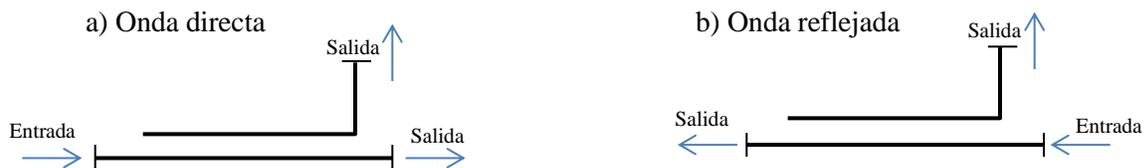
Figura 4.1 Muestra las direcciones de conducción del acoplador direccional.
