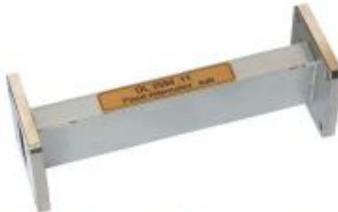
El objetivo del atenuador fijo es proporcionar una atenuación fija de 6 dB. La atenuación se obtiene mediante la inserción de un absorbente conductor delgado en una sección recta de una guía de ondas estándar.
