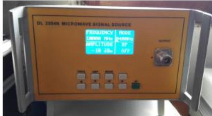
Es un nuevo tipo de generador de señal de microondas, basado en un lazo cerrado de fase controlada digitalmente, con alta estabilidad de frecuencia y bajo ruido de fase. Tiene dos modos de salida de señal, modo de onda continua y modo de modulación por desplazamiento de amplitud. Los alumnos disponen de una señal de modulación de onda cuadrada incorporada de 400Hz ~ 4KHz para la configuración. El rango de frecuencia de salida de la banda S a la banda Ku puede ser elegido por los alumnos.
