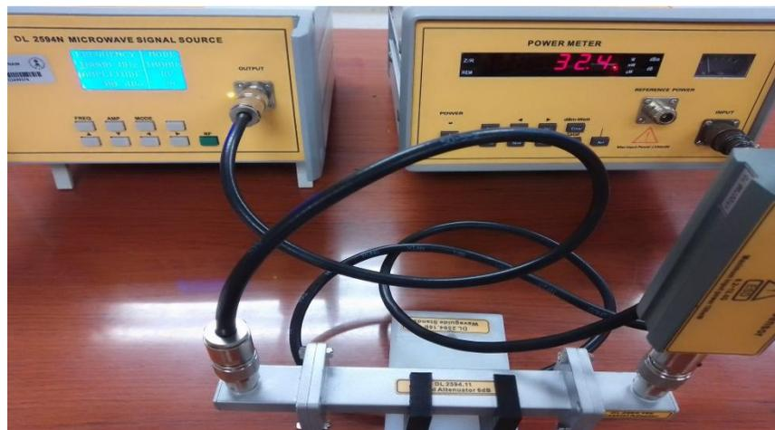
Figura 3.2 Vista de la aplicación del atenuador 6 dB
