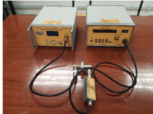
6. Conecte la guía de ondas entre los dos adaptadores coaxiales como se muestra a continuación. Presione la tecla (RF) para habilitar la señal de salida RF y registre la potencia medida en dBm. Al finalizar la medición, presione nuevamente la tecla (RF) para deshabilitar la señal de salida RF. *Incluya evidencia de las conexiones realizadas* y anote sus comentarios.
