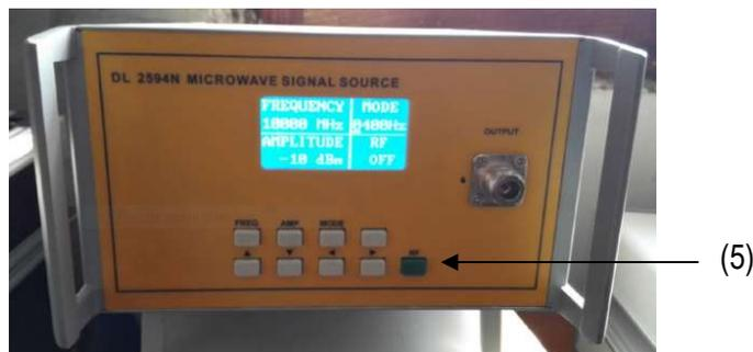
4. Configure la Fuente de Señal de Microondas para una frecuencia de la señal de salida de 10GHz, una potencia de 0dBm y el modo de onda continua (apéndice B).
