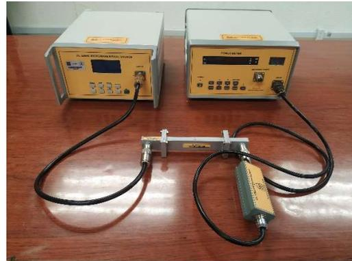
8. Sustituya el Atenuador Fijo de 6dB por el Atenuador Variable como se muestra a continuación. Presione la tecla (RF) para habilitar la señal de salida RF. Ajuste el Atenuador Variable a 0 y registre la potencia medida en dBm. Después ajuste el Atenuador Variable a 20 y registre la potencia medida en dBm. Al finalizar la medición, presione nuevamente la tecla (RF) para deshabilitar la señal de salida RF. *Incluya evidencia de las conexiones realizadas* y anote sus comentarios.
