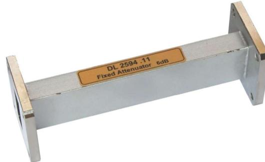
El objetivo del atenuador fijo es proporcionar una atenuación fija de 6 dB. La atenuación se obtiene mediante la inserción de un absorbente conductor delgado en una sección recta de una guía de ondas estándar.
