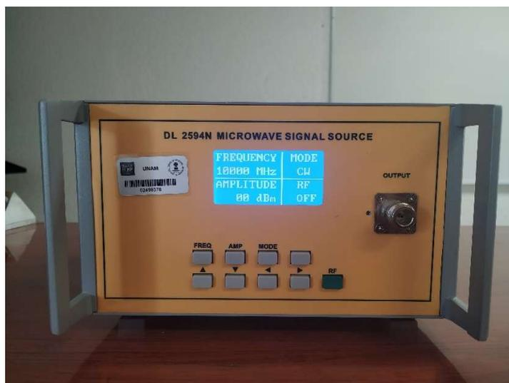
5. Configure el Kit de Microondas como se muestra a continuación y ajuste la frecuencia del Medidor de Potencia a 10GHz (apéndice B). Presione la tecla (RF) de la Fuente de Señal de Microondas para habilitar la señal de salida RF y registre la potencia medida en dBm. Al finalizar la medición, presione nuevamente la tecla (RF) para deshabilitar la señal de salida RF. *Incluya evidencia de las conexiones realizadas* y anote sus comentarios.
