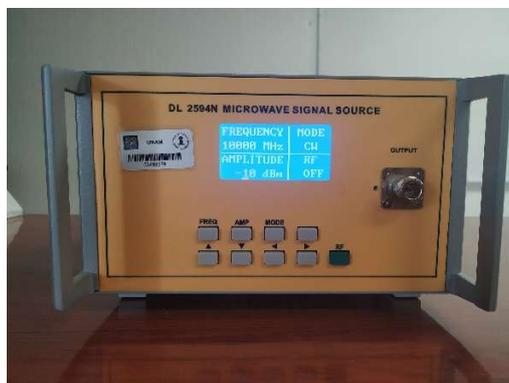
5. Conecte el cable de alimentación del Medidor de Potencia y ajuste la frecuencia a 10GHz (apéndice B).
