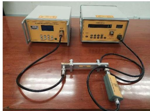
7. Sustituya la guía de ondas por el Atenuador Fijo de 6dB como se muestra a continuación. Presione la tecla (RF) para habilitar la señal de salida RF y registre la potencia medida en dBm. Al finalizar la medición, presione nuevamente la tecla (RF) para deshabilitar la señal de salida RF. *Incluya evidencia de las conexiones realizadas* y anote sus comentarios.
