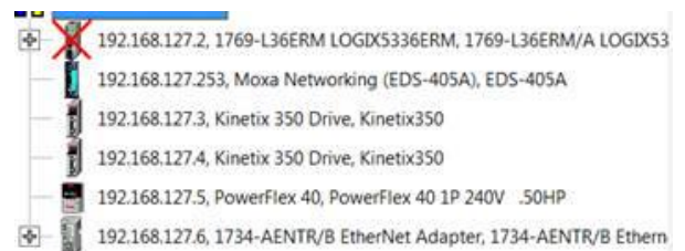
Figura 20.- Pérdida de comunicación RSLinx.
