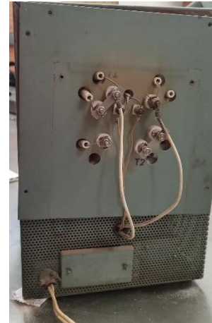
Figura 2.- Conexión posterior de la mufla. (Autoría propia)
