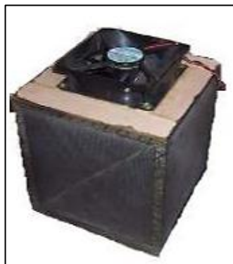
Figura 10.- Colocación del ventilador para PC en la parte superior del filtro.
