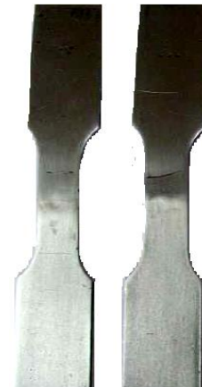
Figura 3. Probetas maquinadas para ensayo a la tensión maquinadas de acuerdo norma ASTM E8M método estándar
