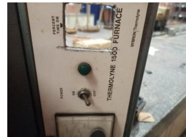
Figura 14.- Modificación: Recorte para colocar el termostato digital. (Autoría propia) Finalmente se realizó la modificación en la carcasa del horno para poder fijar el pirómetro digital, Figura 14.
