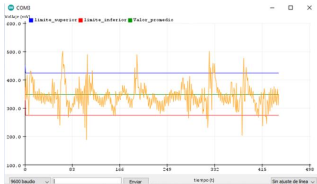
Figura 6.- Gráfica experimental del controlador ON – OFF con histéresis.
