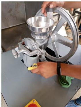
Figura 11. Prueba de limpieza (Fotografía tomada por los autores).
