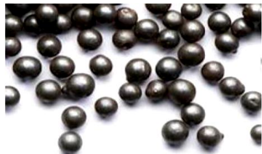
Figura 4. Bolas de acero clasificado según un número característico normalizados según la norma SAE en el Standard SAE J444
