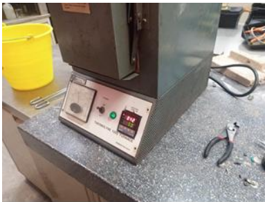
Figura 15.- Mufla funcionando en la práctica de templado. (Autoría propia)
