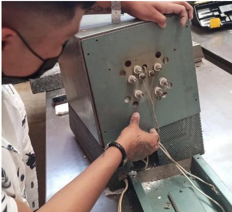
Figura 4.- Desconexión de los cables. (Autoría propia)
