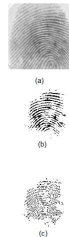
Figura 4.- Obtención de imágenes de huellas digitales mediante el procedimiento de percolación de fluido newtonianos. En (a) imagen original, en (b) imagen binarizada (0,1), en (c) el resultado final de la operación.
