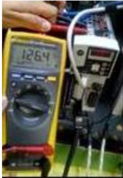
Figura 15.- Prueba de tensión en el servodrive 1.
