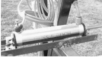
Figura 13. Pistón Neumático
