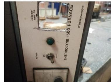
Figura 14.- Modificación: Recorte para colocar el termostato digital. (Autoría propia)
