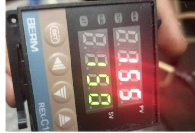
Figura 13.- Comprobación de funcionamiento del termostato. (Autoría propia)
