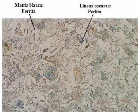
Figura 4. Microestructura acero A36 original
