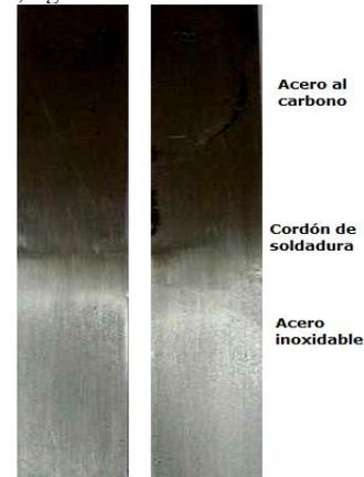
**Figura 2.** Probetas soldadas
