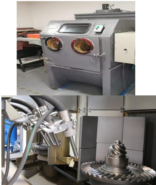
Figura 8. Equipos de Shot Peening
