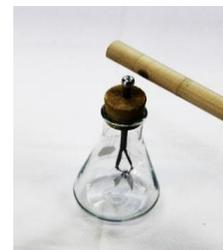
Figura 7. Detección de carga con el electroscopio de láminas.
