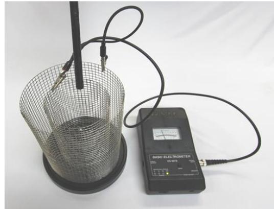
Figura 10. Electrómetro Pasco
