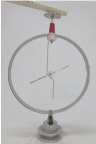
Figura 8. Electroscopio de punta
