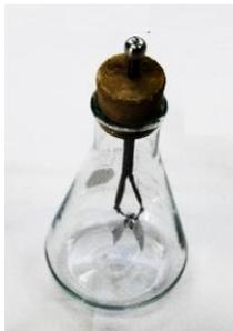
Figura 1. Electroscopio de Láminas
