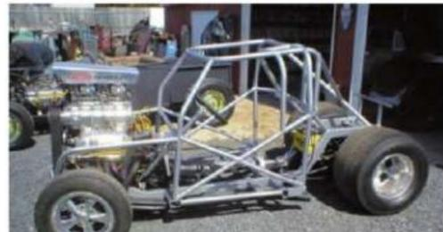
Figura 3. Prototipo de un vehículo de chasis tubular.
