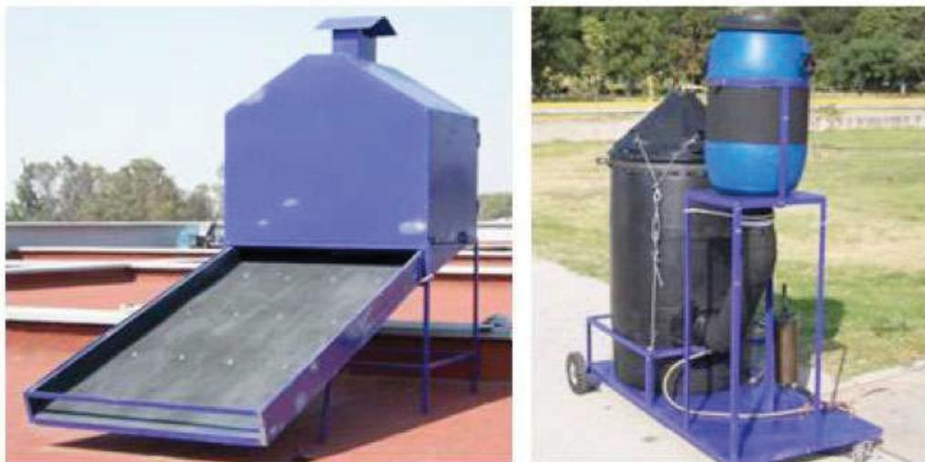
Figura 6. Secador y biodigestor
