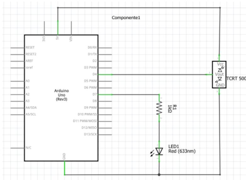
Fig. 1.- Sistema para probar la conexión entre Matlab y Arduino.
