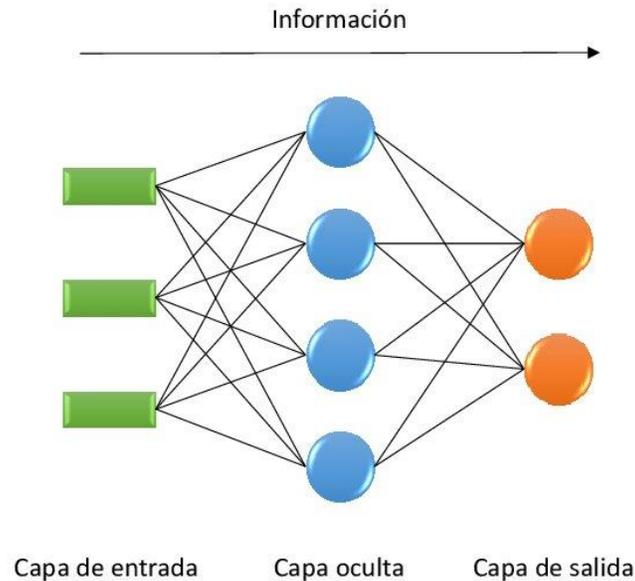
Fig. 1.- Esquema básico de una red neuronal, se ve una red con tres neuronas de entrada, dos neuronas de salida, y cuatro neuronas en su capa oculta. Imagen recuperada de <file:///C:/Users/Vegueta/Downloads/Tesis-LinoFranciscoManjarrezMontao.pdf>
