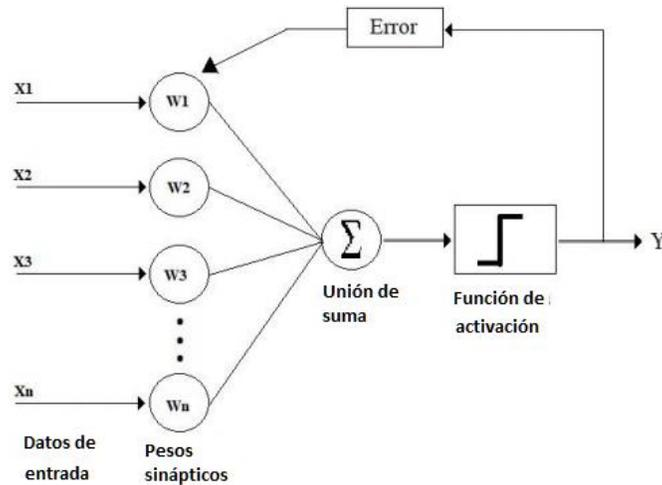
Fig 1.- Configuración y representación básica de un perceptrón.
