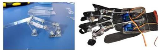
Fig. 12. Armado de las falanges “Estructra de la mano”
