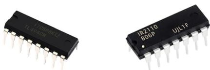
Fig. 3. Circuitos integrados TL494CN y IR2110.
