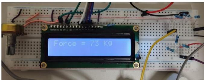
Figura 7. Señal de deformación mostrada en el LCD.
