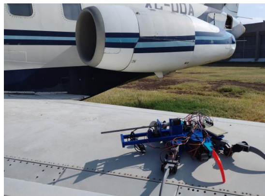
Fig. 4. Robot hexápodo con el escaner durante la digitalización del daño.
