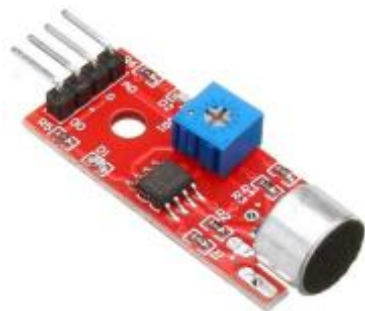
Fig. 5. Sensor de ruido KY-037.
