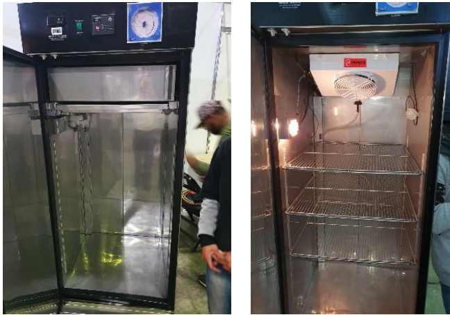
Fig.3. Fotografías de los dos refrigeradores para vacunas de 17.6 pies 3 de la Marca: Ojeda Modelo:RVBM-500, utilizados en el proceso de pruebas, en la fotografía de la izquierda se presenta el refrigerador que hace uso de su cámara de refrigeración como mecanismo de enfriamiento por convección al tener ubicado el congelador en su parte superior, y que cuenta con un difusor en la parte trasera del mismo, lo que permite mantener la temperatura homogénea y constante en su interior; y en la fotografía de la derecha el refrigerador acondicionado con el sistema de difusión de la Marca: OYON Modelo: OEJ-1D.
