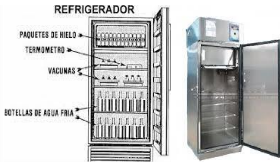
Fig.1. Los refrigeradores y congeladores son equipos que se utilizan para almacenar vacunas, estos pueden ser dispositivos independientes o combinados que permiten manejar una temperatura de almacenamiento entre 2 °C y 10 °C.
