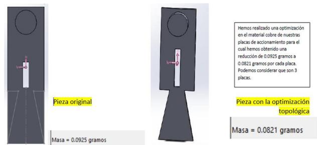
Figura 9. Pieza con optimización topológica
