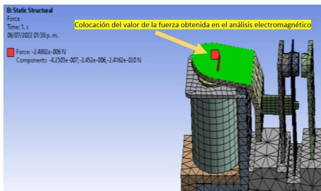
Figura 7. Colocación de la fuerza en el análisis mecánico estructural
