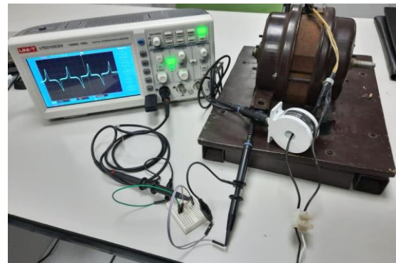
Figura 10. Conexión del transformador de corriente en la línea de alimentación del motor
