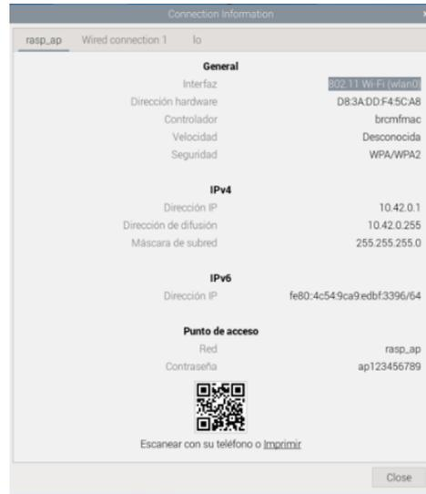
Fig. 6. Creación de Wi-Fi Hotspot para interconexión de dispositivos IoT
