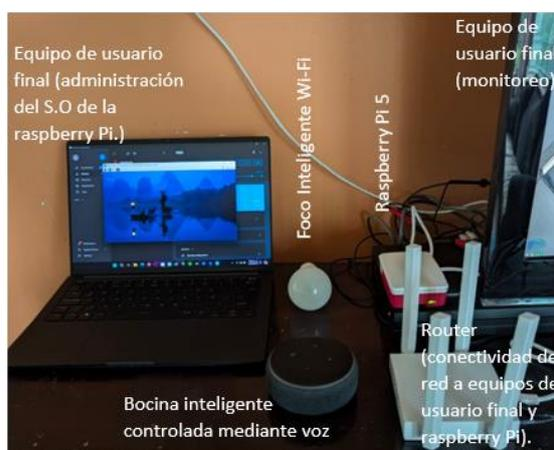
Fig. 3. Interconexión de prototipo de proyecto en ubicación doméstica.
