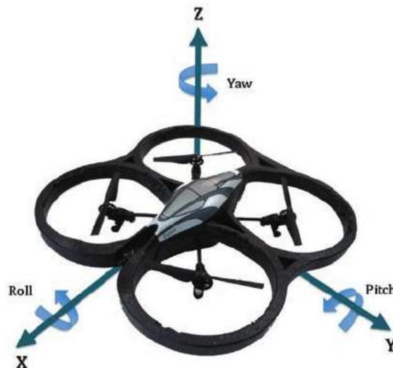
Fig. 3. Ejes de referencia para las velocidades angulares del AR Drone [9].
