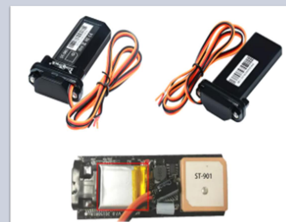
Figura 13. Modulo rtk-gps st-901.
