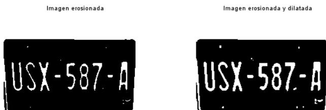
Fig. 7. Imagen erosionada y dilatada.
