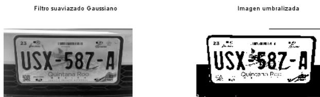
Fig. 3. Imagen con filtro gaussiano y umbralizada.
