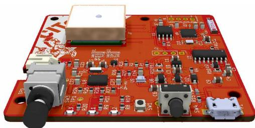
Fig. 1. Dispositivo de Adquisición de parámetros de vuelo ( DAPV)
