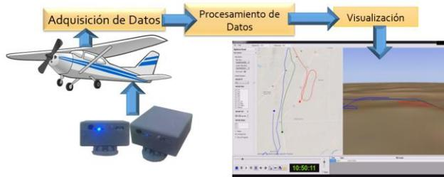
Fig. 2. Diagrama del sistema de post-procesamiento de datos.
