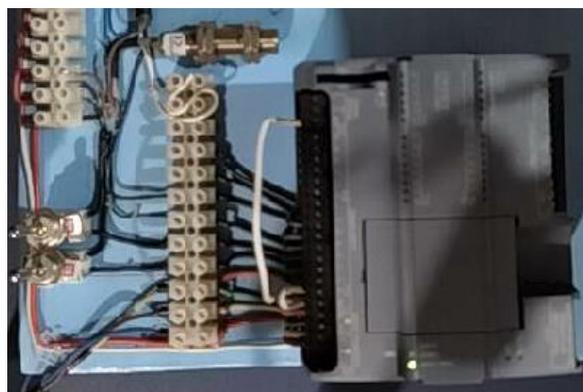
Figura 7. PLC físico para control del proceso.
