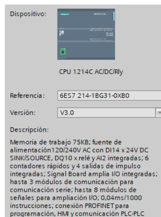
Figura 6. Configuración de PLC en Software.
