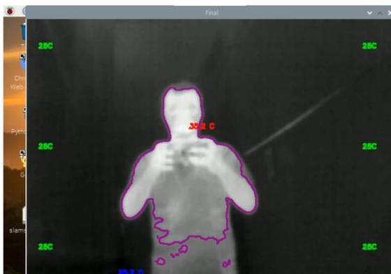
Figura 12: Medición de  $35^{\circ}\pm 3^{\circ}$  C de una persona en un pasillo con 6 puntos de control de temperatura a  $26^{\circ}\pm 3^{\circ}$  C.
