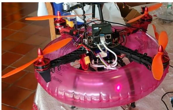
Figura 1: VANT Con Frame 450, motores RacerStar<sup>[8]</sup> y batería LiPo.<sup>[7]</sup>
