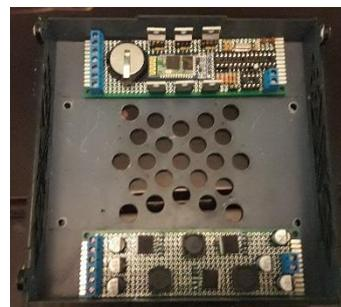
Figura 11 Disposición de los circuitos dentro del gabinete visto desde arriba.
