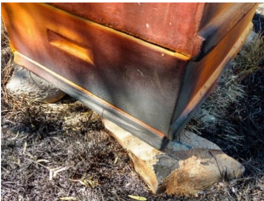
Figura 8. Exterior de colmena de poliuretano con mayor área quemada
